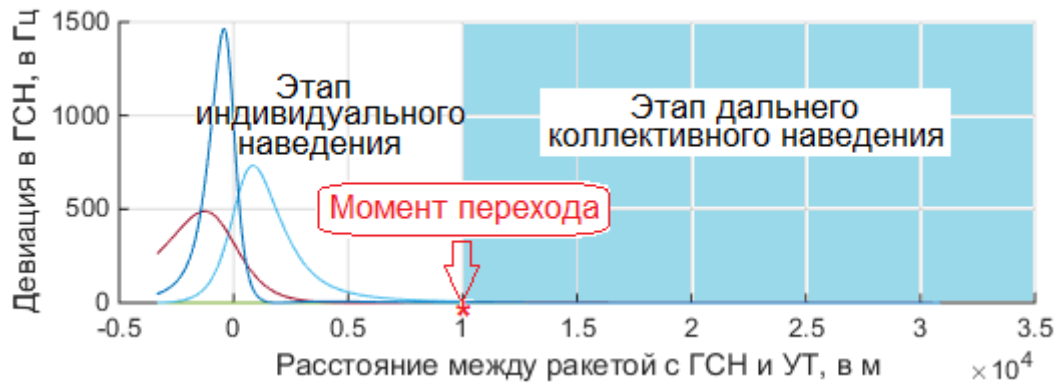
Рисунок 2 – Зависимость девиации частоты \Delta f_{n_r, n_{gvc}} принимаемого в ГСН ракеты сигнала на различных этапах наведения
